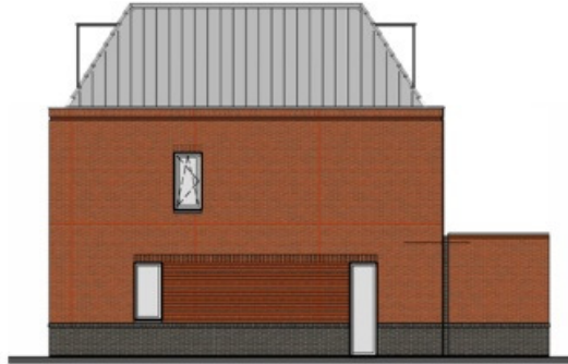
KOPGEVEL ELBURGHUIS MET DAKOPBOUW 2 EN UITBOUW AAN ACHTERZIJDE
